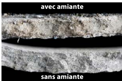
Fibrociment avec ou sans amiante
