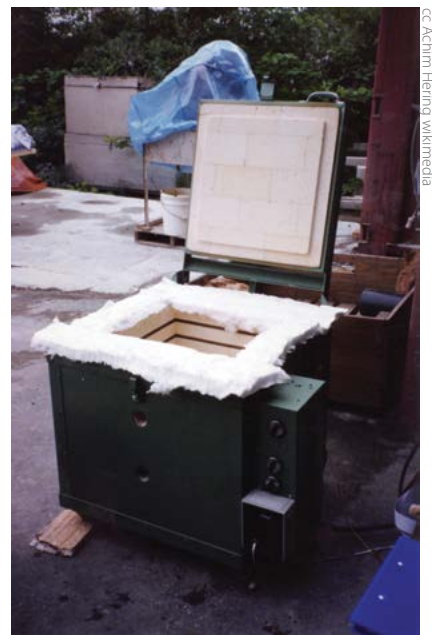
Isolation d'un fourneau avec des fibres céramiques
