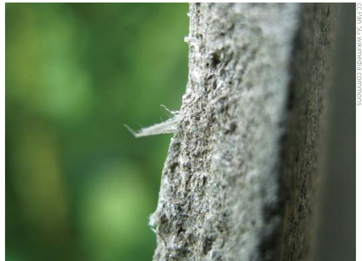
Fibres d'amiante liées dans une matrice à base de ciment
