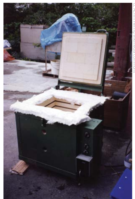
Isolatie van een oven met keramische wol
